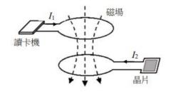
常用的晶片卡中有內建線圈,如示意圖的下半部所示,向左箭號代表應電流  $I_2>0$  的流向。圖的上半部為讀卡機線圈,向右箭號代表電流  $I_1>0$  時的流向。當  $I_1>0$  時線圈產生的磁場,如虛線所示。晶片卡線圈貼近讀卡機線圈時,電流  $I_1$  產生的磁場會造成應電流  $I_2$  的變動,驅動晶片發出訊息。當兩線圈均為靜止且  $I_2=0$  時,欲使晶片卡線圈產生圖示  $I_2>0$  流向的應電流,則讀卡機線圈的電流  $I_1$  應如何?(應選 2 項)
